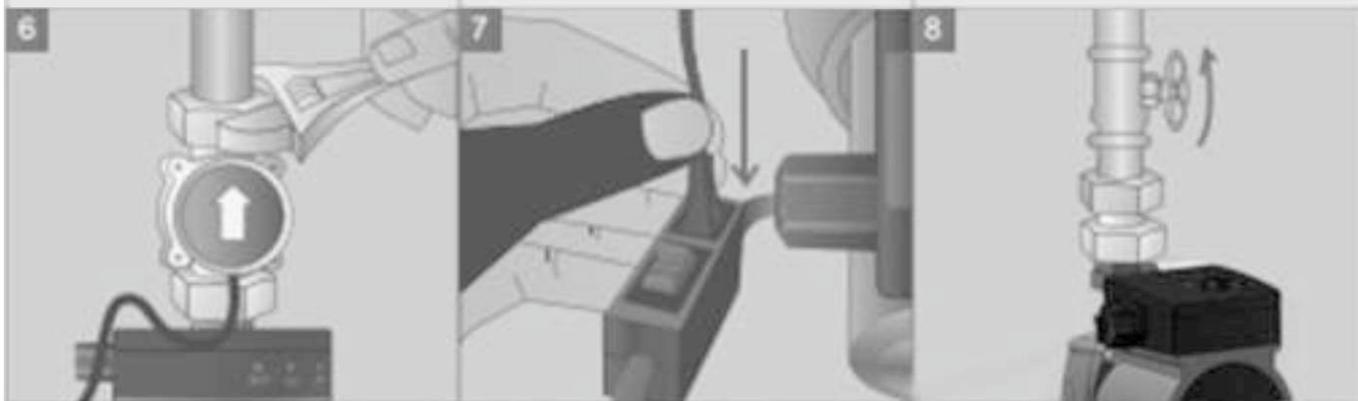
Instale o controlador/fluxostato na saída da bomba
